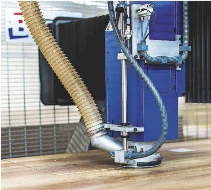
Druckluft verhindert ein Kratzen der Glocke über die Oberfläche
