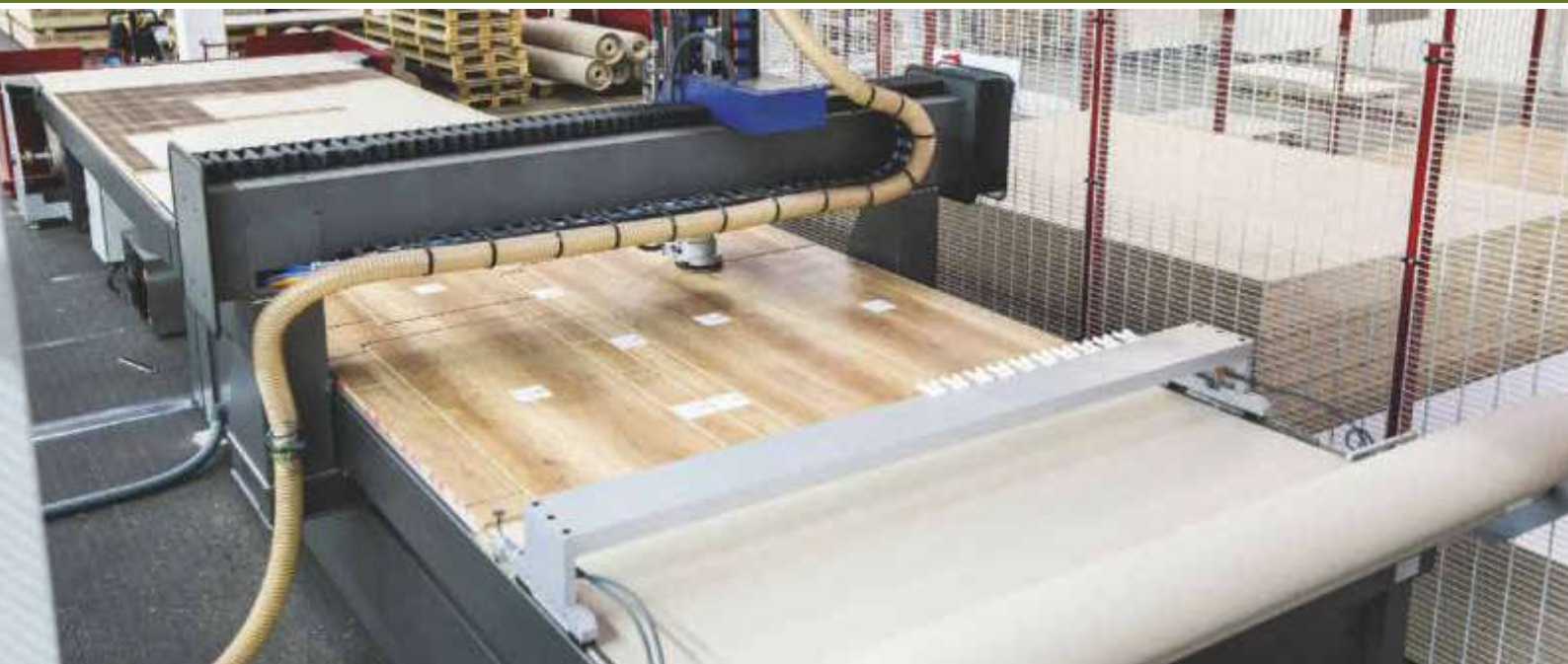
Die Nesting-Maschine im Einsatz: Mit einem Schafffräser teilt sie die Platte auf. Eine Glocke erfasst zuverlässig allen Staub
