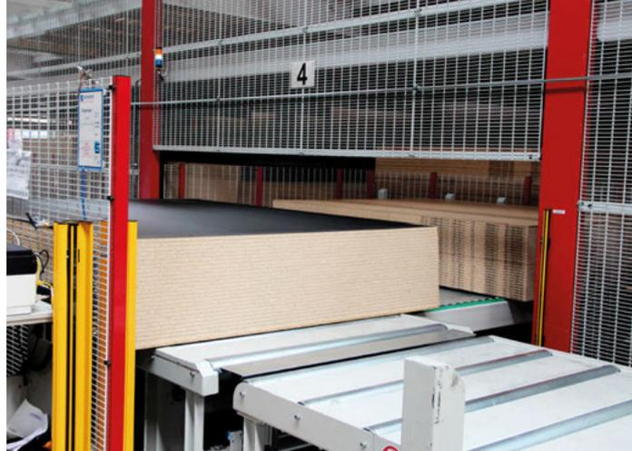
Während keine Aufträge bearbeitet werden, organisiert die Software das Lager selbstständig um. Auf dem Bild ist zu sehen, wie neue Platten eingelagert werden.
