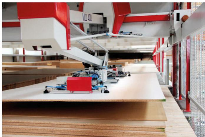
Anheben von Platten mittels Unterdrucks.
