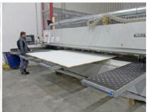
Das Flächenplattenlager mit angeschlossenen automatisiertem Zuschnitt. Bewegt werden die Platten schonend über Roboter mit Saugnapfen.
